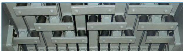
ビームの間隔を常に均一に保つためのゴムのせん断ばねを利用したコントロール機構が組み込まれております。
