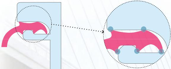
止水ゴムはしっかりとエンドビーム、ミドルビームにはめ込まれており、ビームと止水ゴムは 5 点で接触し、完全な水密性を確保しています。
